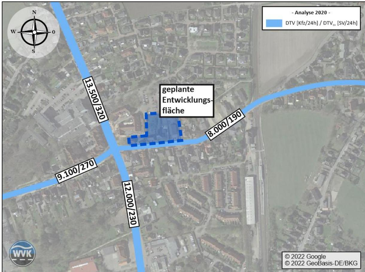
Abbildung 2.5: Analyse 2020 - DTV,  $DTV_{SV}$
