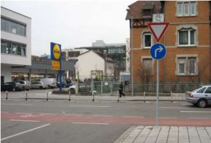
Bild 4 Sicherheitserhöhende Kennzeichnung einer Radwegfurt mit Zweirichtungsbetrieb (Stuttgart)
