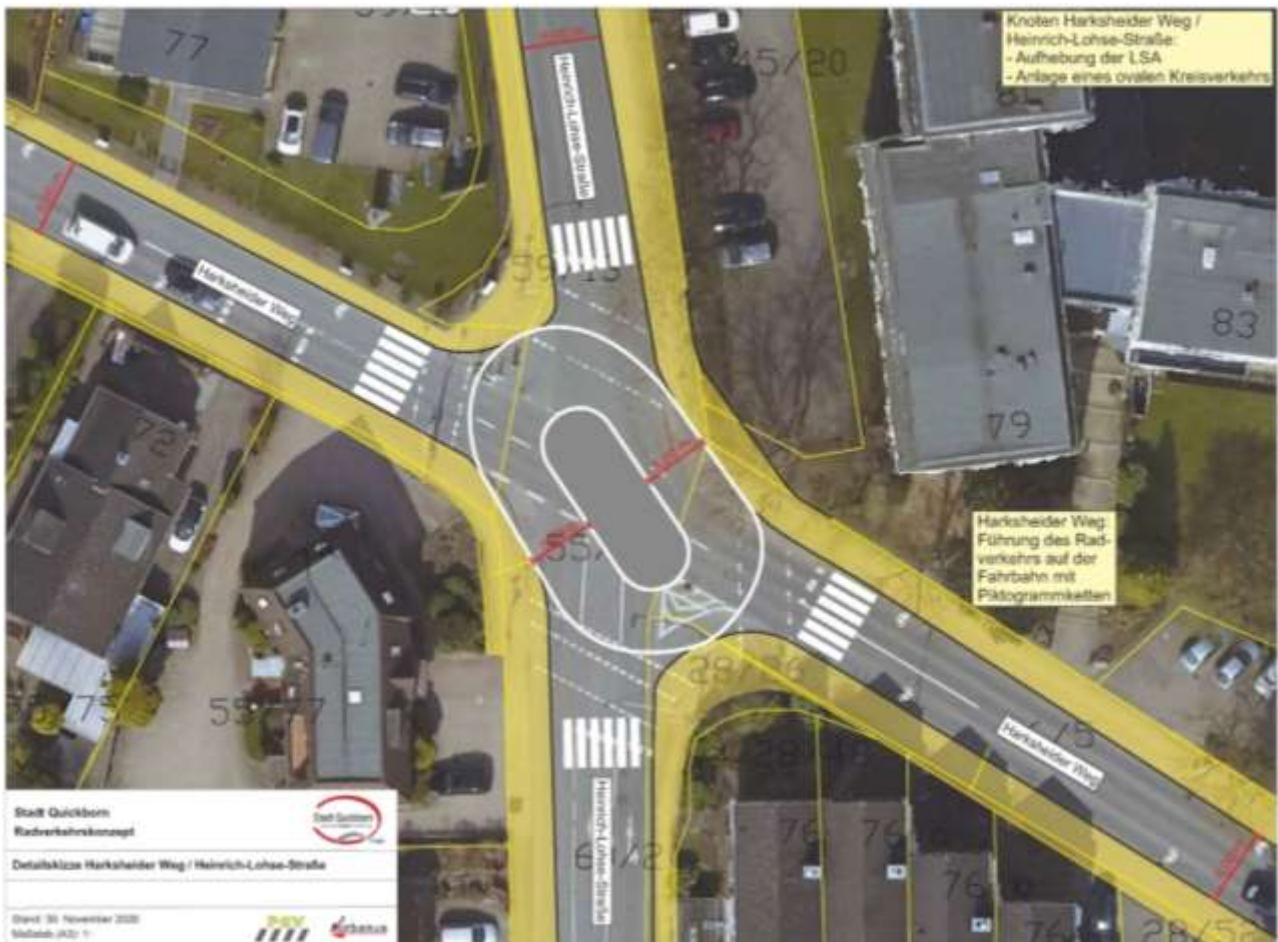
Bild 58 Prinzipskizze für die Anlage eines ovalen Kreisverkehrs im Knoten Harksheider Weg / Heinrich-Lohse-Straße
