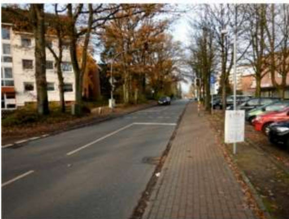
Harksheider Weg: Beengter Straßenraum mit schmalen Seitenräumen und aufgehobener Radwegebenutzungspflicht. Konflikte in der Fahrbahn mit Kfz- und Linienbusverkehr.
