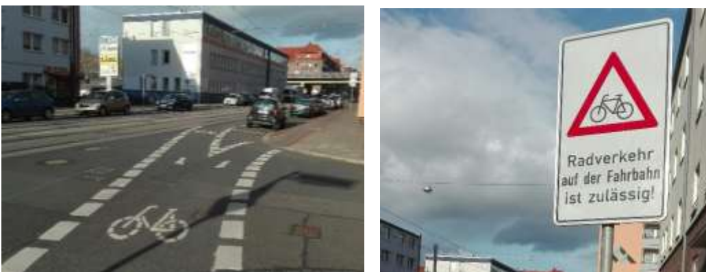
Bild 57 Beispiel für gezielte Hinführung des Radverkehrs in den Mischverkehr auf der Fahrbahn (Hannover) und Hinweisende Beschilderung zur erlaubten Fahrbahnführung (Hannover)
