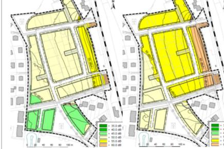
Abbildung 2: Maßgeblicher Außenlärmpiegel für schutzbedürftige Räume. Abbildung 3: Maßgeblicher Außenlärmpiegel für Räume, die überwiegend zum Schlafen genutzt werden.
