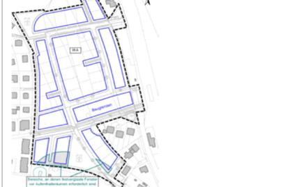
Abbildung 1: Bereiche, an denen festverglaste Fenster vor Außenbalkonen zum Schutz vor Sportlärm erforderlich sind. Von den vorgenannten Festsetzungen kann abgewichen werden, wenn im Rahmen eines Einzel-nachweises ermittelt wird, dass aus der tatsächlichen Lärmbelastung an den Gebäudeseiten die Anforderungen der 18. BImSchV durch den Sportlärm eingehalten werden.
